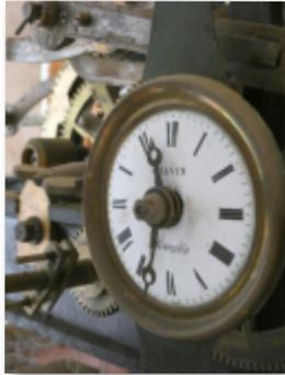
Au premier étage du clocher, se trouve une horloge mécanique installée par Joseph Chavin en 1870. L'horloge, fabriquée par Arsène Cretin-l'Ange (Morbier, Jura) est à deux corps de rouage (un rouage pour le mouvement et un rouage pour les sonneries). L'horloge sonnait les heures et
