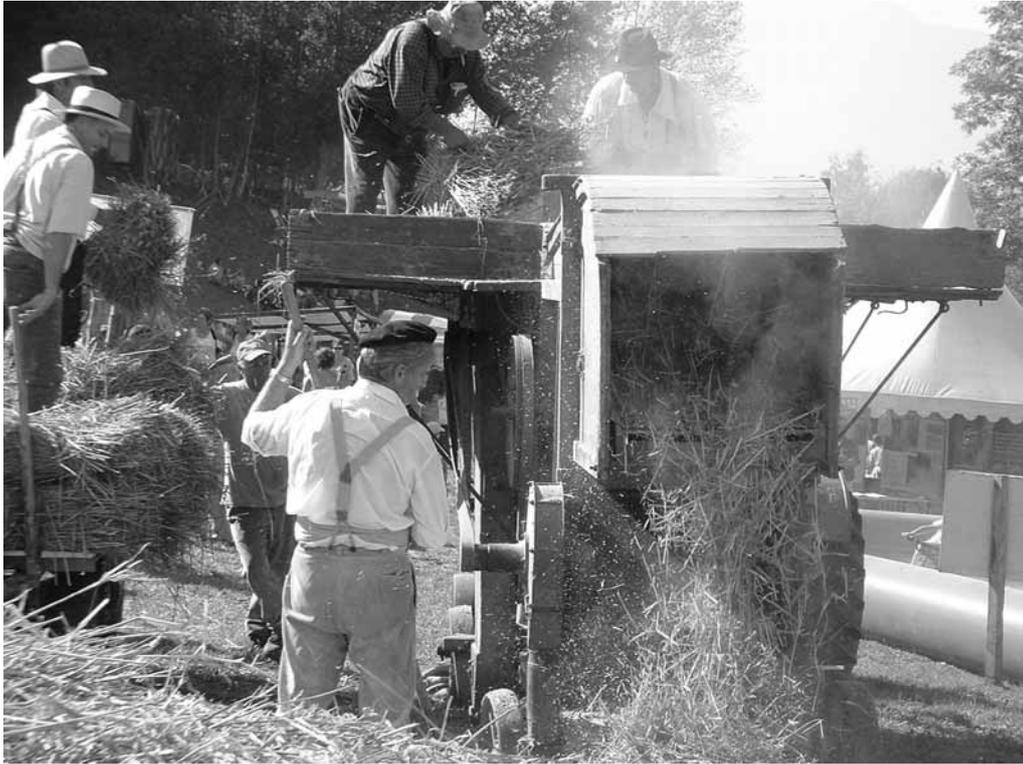
« Je suis née en Tchécoslovaquie et achetée par la CUMA de Revel en 1927. D'abord équipée d'un moteur électrique, je suis depuis 1960 entraînée par poulie depuis un tracteur. Depuis 1927 et jusqu'en 1993, je travaillais de ferme en ferme pour battre les gerbes de blé entreposées dans les granges. Par soucis d'équité, je commençais la saison de battage par le hameau de la tour ( bas de
